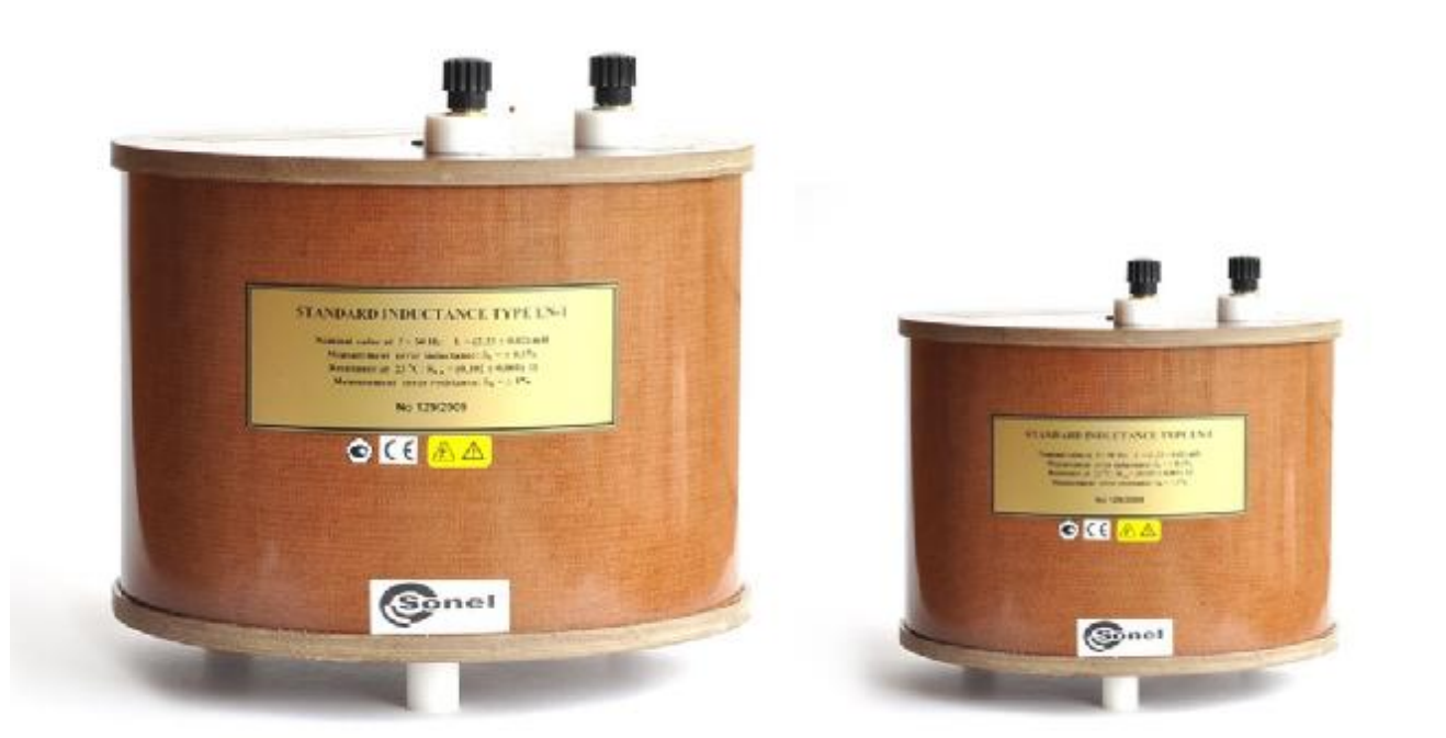
Рисунок 1 - Фотография общего вида катушек индуктивности силовой цепи эталонных LN-1.
