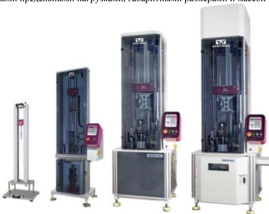
Рис. 1 Общий вид систем с падающим грузом для измерения параметров ударных испытаний (копров вертикальных) серии 9300.
