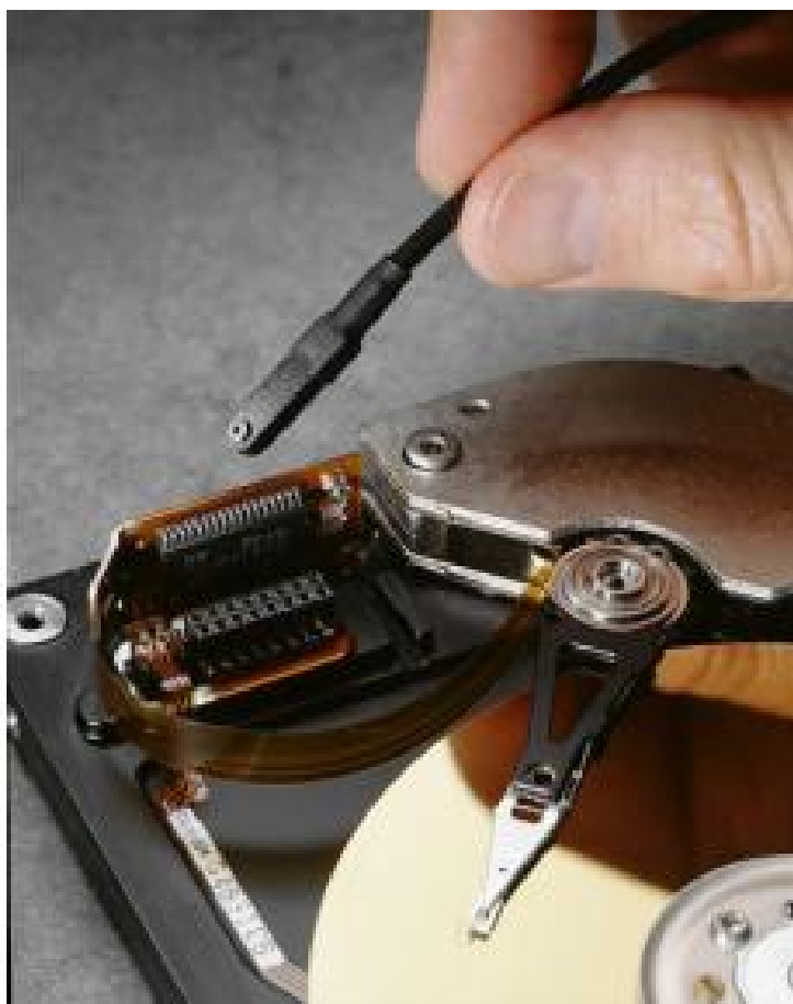
Рисунок 1 – Пробник токовый СТ6, подключаемый к измерительному объекту
