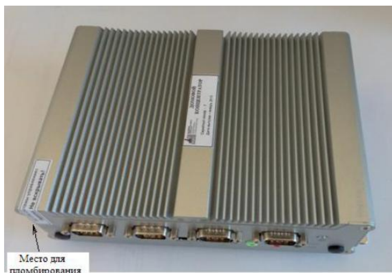
Рисунок 1 - Место пломбирования домового концентратора.
