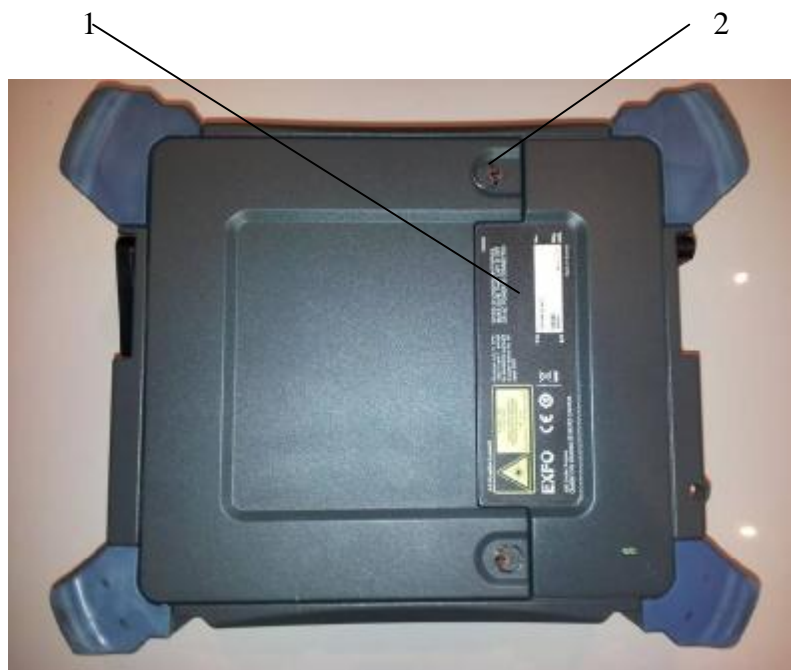
Рисунок 2 - Схема корпуса систем оптических измерительных FTB-500 (вид сзади) 1 – место нанесения маркировки; 2 – место нанесения защитной наклейки
