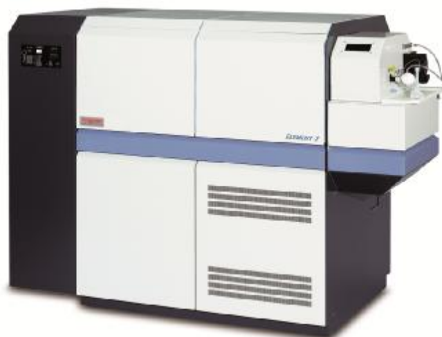
Рис. 1. Фотография внешнего вида масс-спектрометра с индуктивно-связанной плазмой Thermo Scientific Element2.
