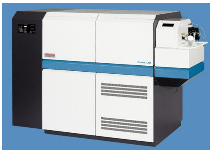
Рис. 2. Фотография внешнего вида масс-спектрометра с индуктивно-связанной плазмой Thermo Scientific Element XR.
