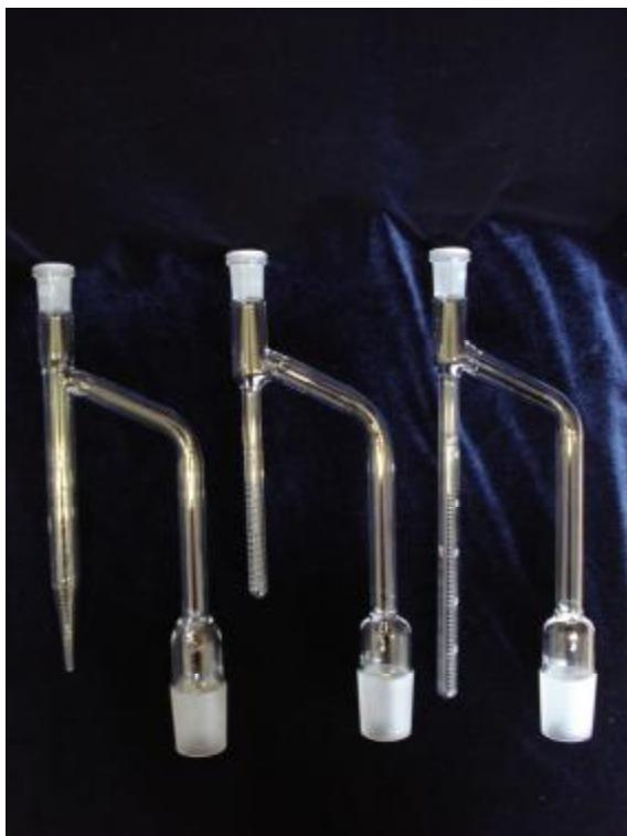
Приемники-ловушки для аппарата АКОВ представляют собой стеклянный градуированный сосуд цилиндрической формы, нижняя часть которого переходит в трубку меньшего диаметра. На корпусе приемника-ловушки нанесена шкала. Верхняя часть приемника-ловушки заканчивается шлифованной горловиной. К корпусу приемника-ловушки выше верхней отметки шкалы припаян отвод со шлифом на конце. Шлифы предназначены для сбора аппарата АКОВ. Шкала имеет 4 диапазона измерения.
