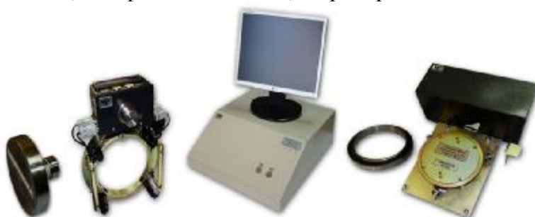
Рисунок 3 – Общий вид Приборов для измерений внутренних и наружных диаметров (модификация УПЛК-01) «Прибор ИКР-01»
