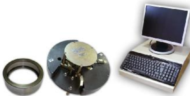
Рисунок 6 – Общий вид Приборов для измерений внутренних и наружных диаметров (модификация УКПП-02) «Прибор ИКР-01»
