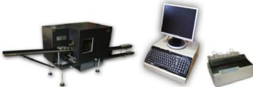
Рисунок 7 – Общий вид Приборов для измерений внутренних и наружных диаметров (модификация УПР-01.3) «Прибор ИКР-01»
