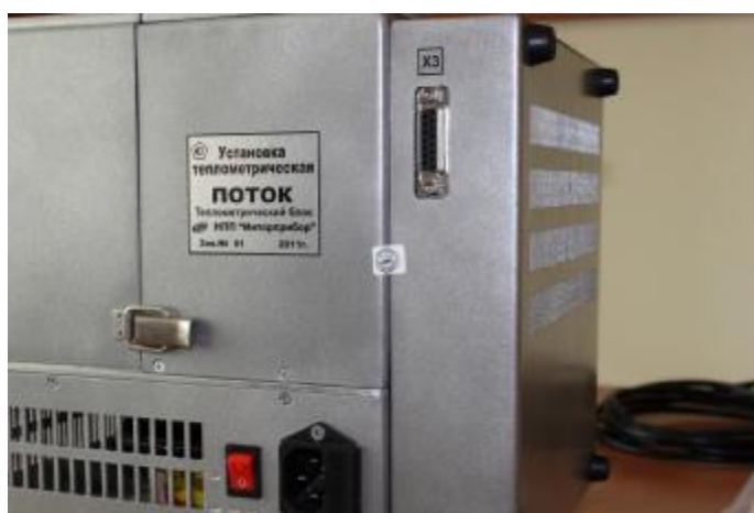
Рисунок 2 – Место пломбирования теплотрического блока
