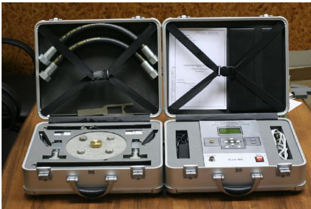
Рисунок 1 –Общий вид влагомеров эталонных (компараторов) товарной нефти поточные УДВН-1эп
