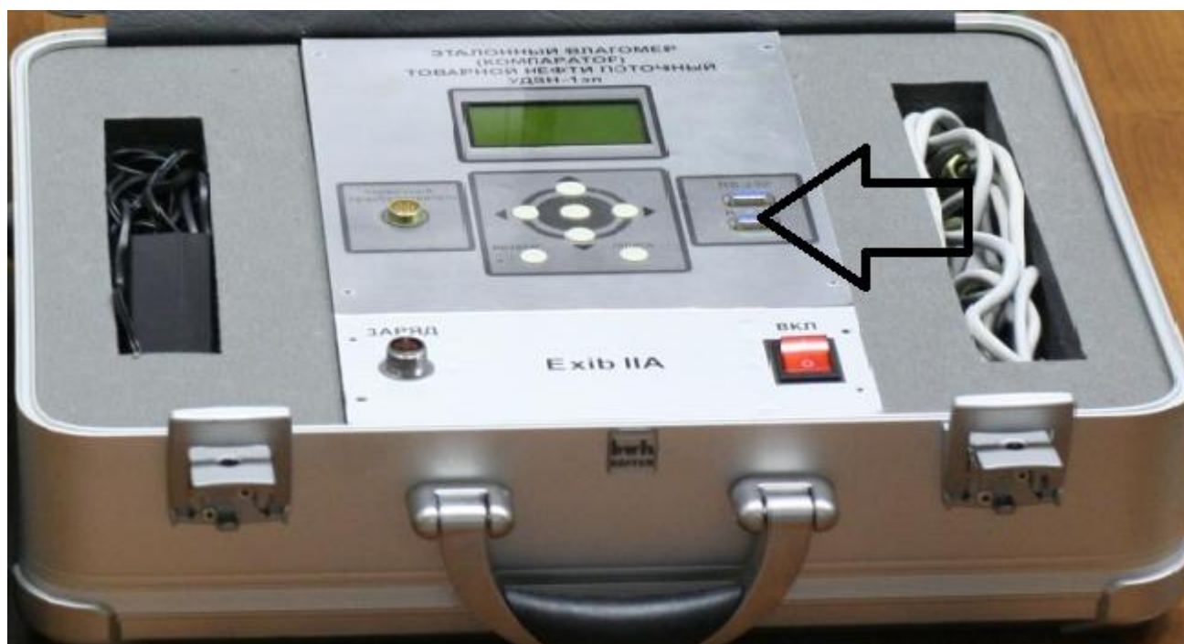
Рисунок 2 - Место пломбирования влагомеров эталонных (компараторов) товарной нефти поточные УДВН-1эп
