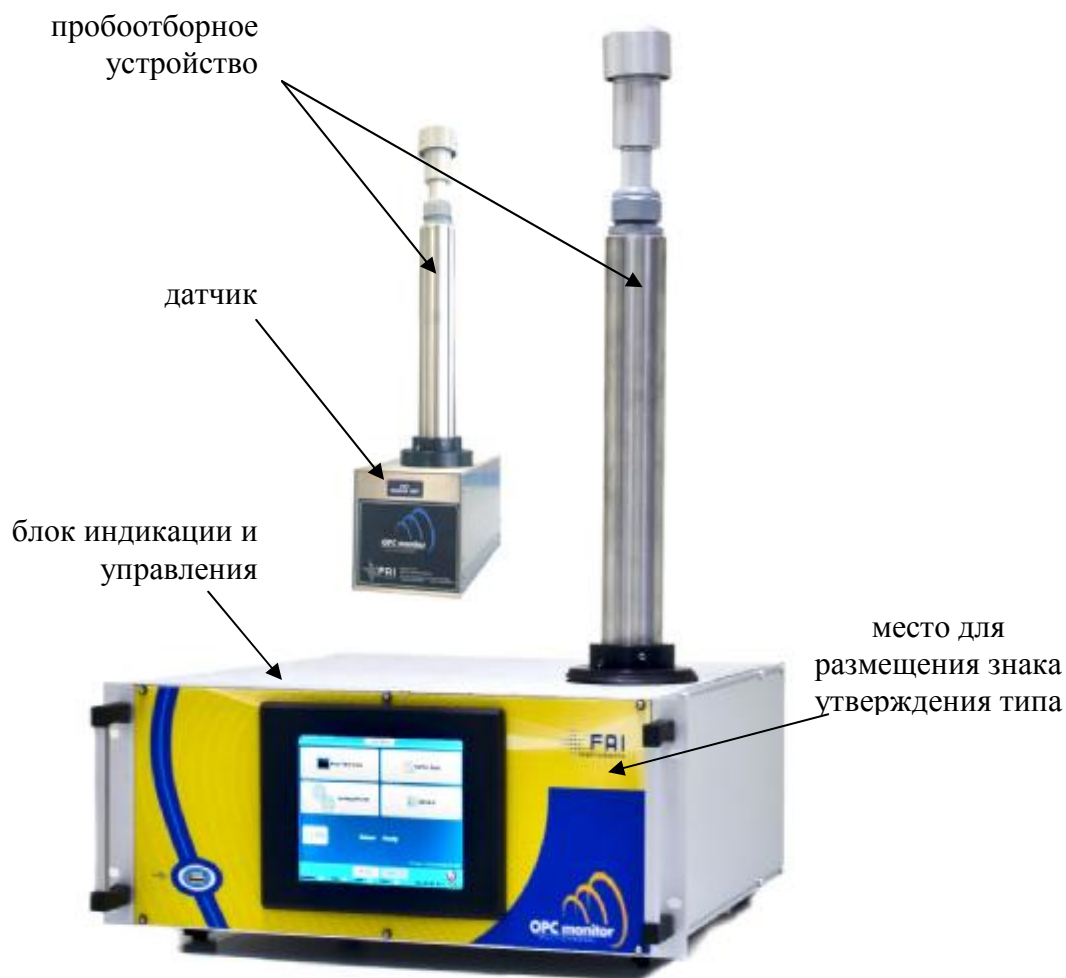
Рисунок 1 – Внешний вид счетчиков аэрозольных частиц OPC Multichannel Monitor и обозначение места для размещения знака утверждения типа
