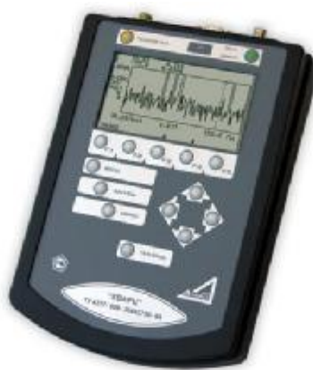
Рисунок 1 - Внешний вид коллектора данных /анализатора КУ80-В
