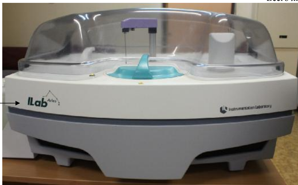
Рисунок 1 – Общий вид Анализатора биохимического ILab Aries
