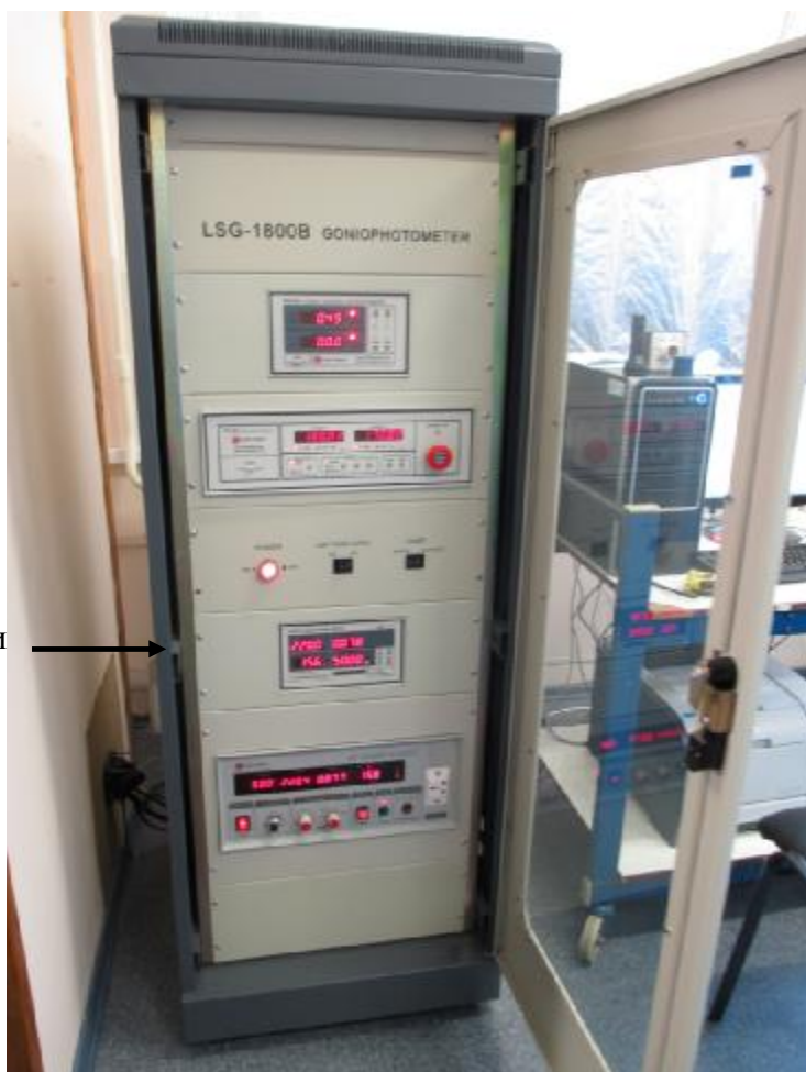
Рисунок 2 – Общий вид стойки управления гониофотометра LSG-1800B с указанием мест маркировки и пломбирования
