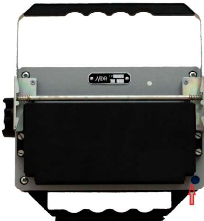
Рисунок 2 – Схема пломбировки от несанкционированного доступа
