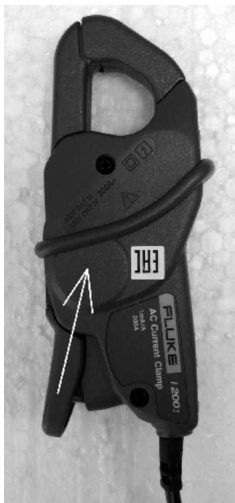
Рисунок 1 - Внешний вид клещей модели Fluke i200 и Fluke i200s, стрелкой показано место нанесения знака утверждения типа.
