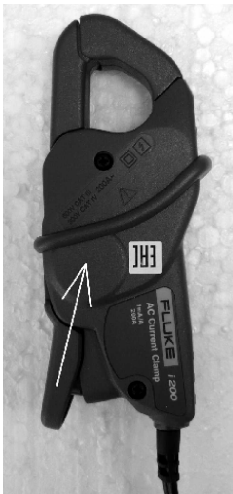
Рисунок 1 - Внешний вид клещей модели Fluke i200 и Fluke i200s, стрелкой показано место нанесения знака утверждения типа.
