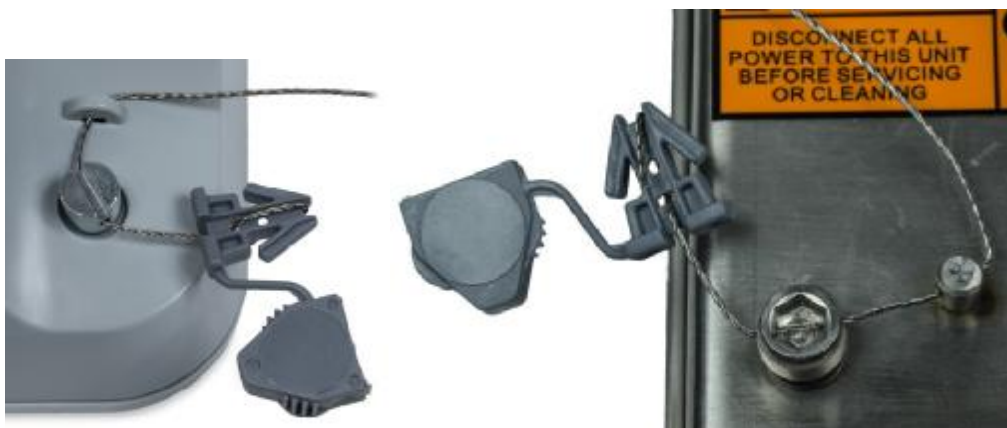
Рисунок 4 - Места пломбировки корпуса терминалов
