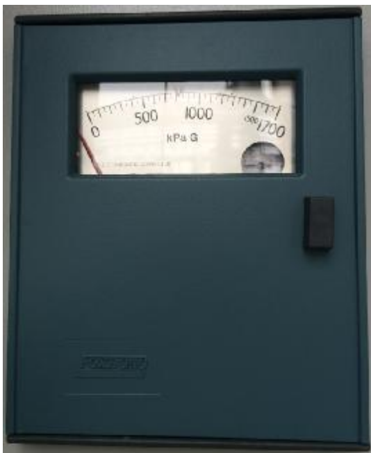
Рисунок 1. Внешний вид прибора контроля пневматического показывающего 4ЗАР-РА45С-РС.
