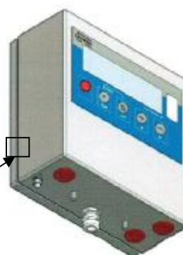
Рисунок 3 - Схема пломбирования от несанкционированного доступа весов технических WPT с индикатором в корпусе из нержавеющей стали.
