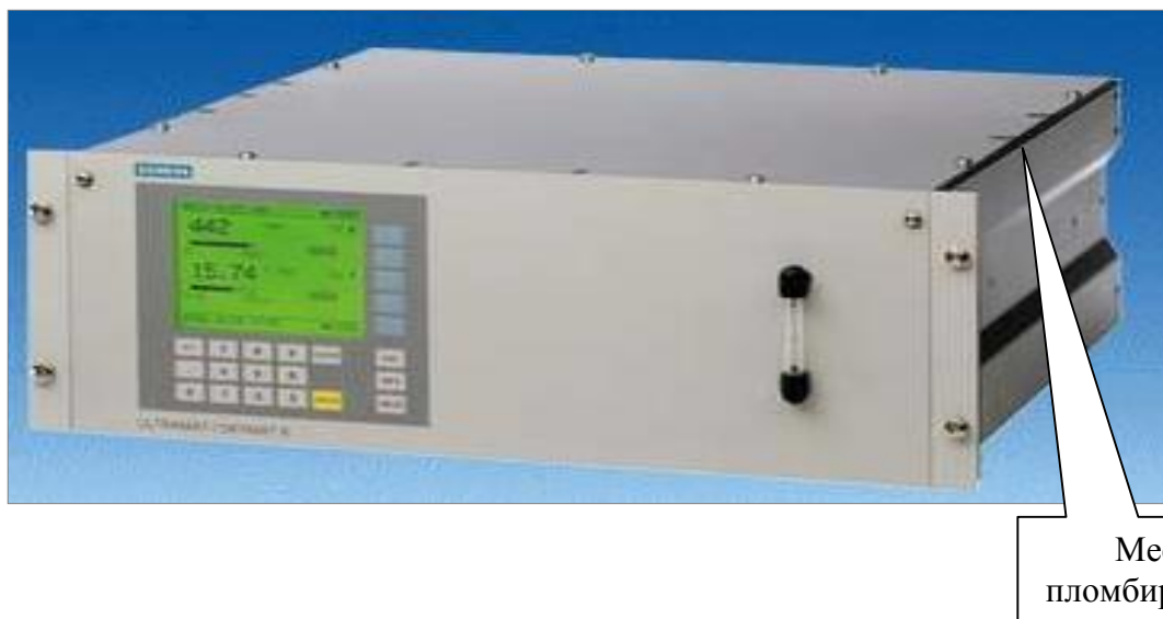
Рисунок 1 – Газоанализатор Ultramat 6E - CH 4 -1 - рабочий эталон 1-го разряда, внешний вид.
