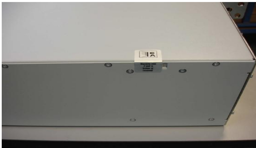
Рисунок 6 – Схема пломбировки источников от несанкционированного доступа
