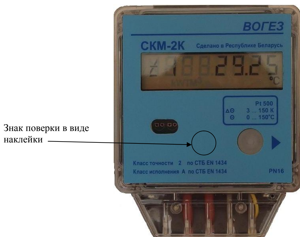
Рисунок 3 – Схема пломбировки счетчиков поверителем
