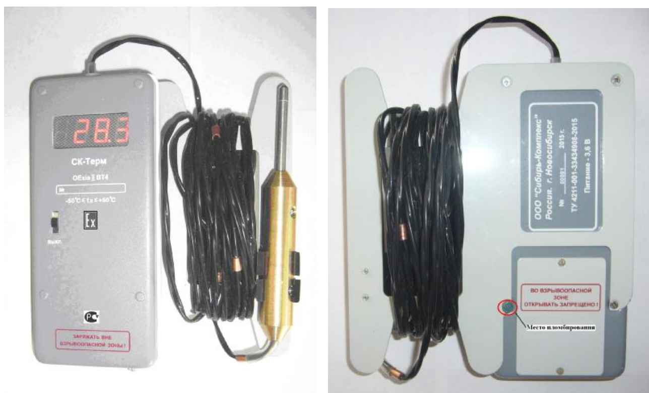
Рисунок 1 – Общий вид и схема пломбирования
