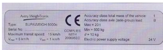
Рисунок 2 - Маркировочная табличка весов SUPAWEIGH 5000c
