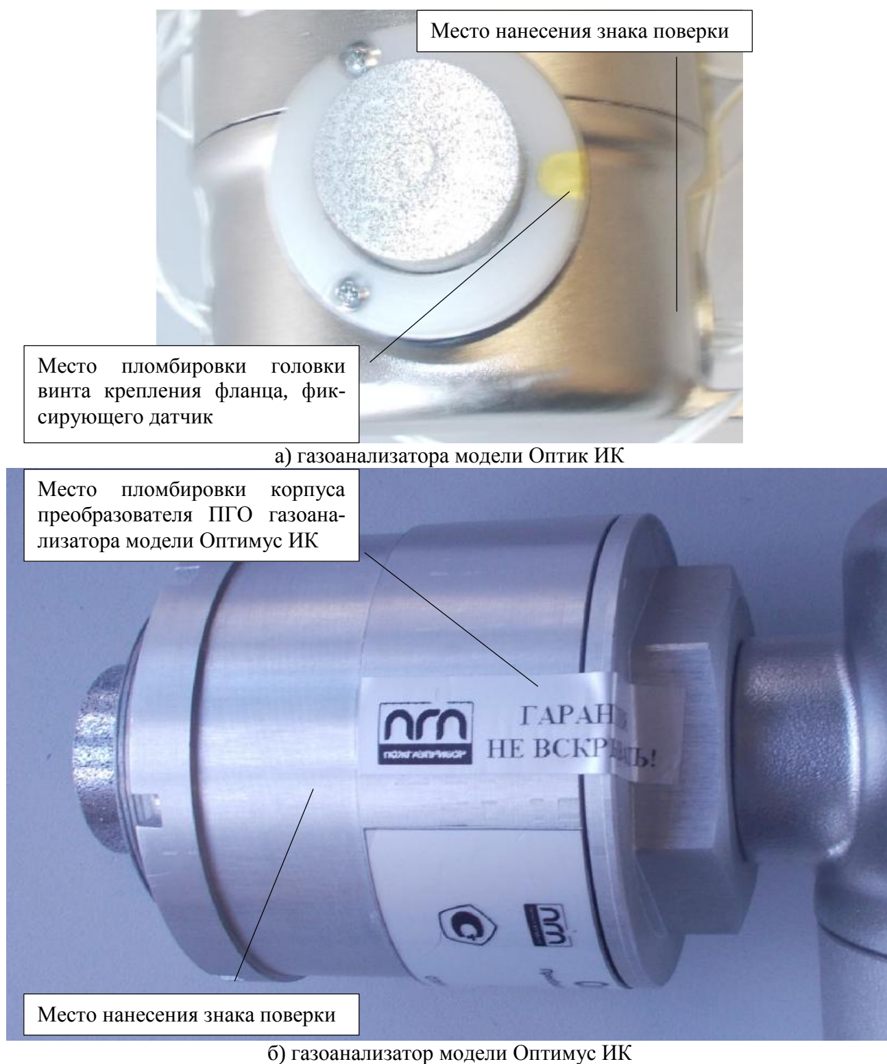
Рисунок 3 – Места пломбировки корпуса газоанализатора от несанционированного доступа
