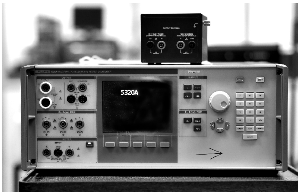
Рисунок 1 - Внешний вид калибратора тестеров многофункционального Fluke 5320A
