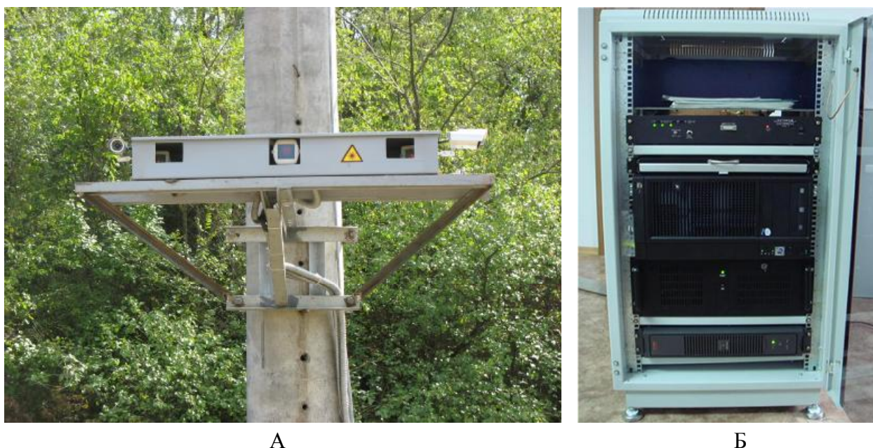
Рисунок 2 – Блок лазерных маркеров (А) и шкаф аппаратный (Б)
