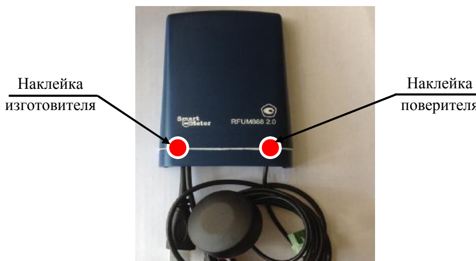
Рисунок 1 – Общий вид УСПД, схема пломбировки
