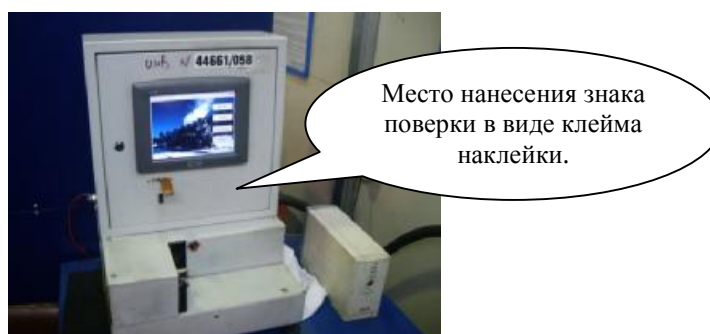
Рисунок 2 – Место нанесения знака поверки в виде клейма-наклейки
