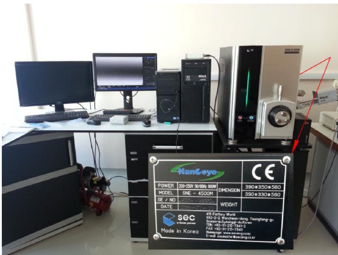
Рисунок 2 – Места нанесения маркировки на микроскоп
