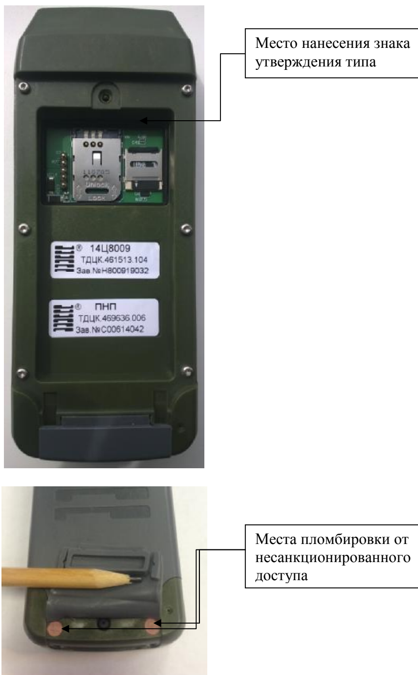
Рисунок 2 - Схема пломбировки от несанкционированного доступа и место нанесения знака утверждения типа
