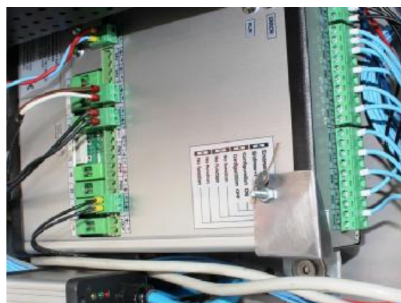
Рисунок 2 – Места пломбировки элементов установки «Corio Duo T»
