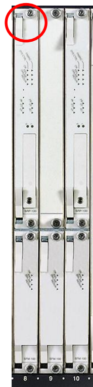
Рисунок 2 Карты коммутации и управления (выделено место блокировки кассет)
