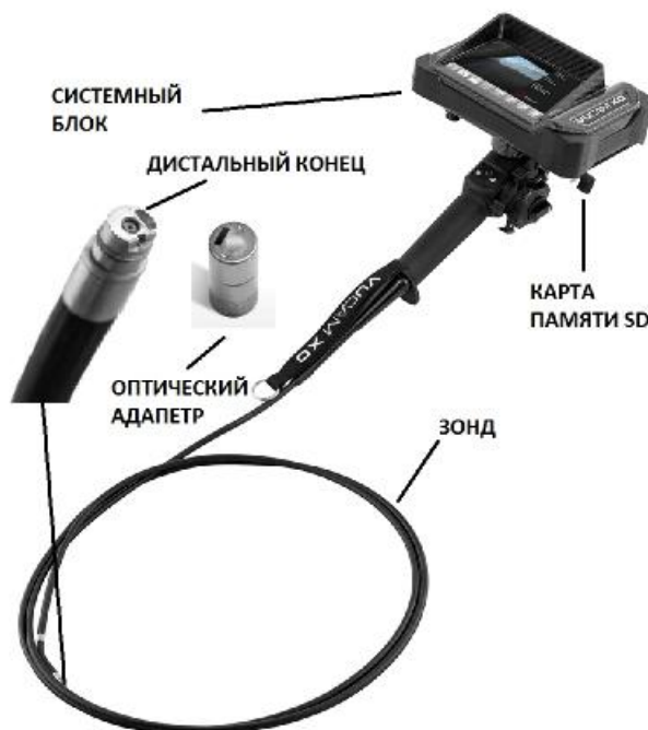
Рисунок 1 - Внешний вид видеоэндоскопов измерительных VUCAM XO
