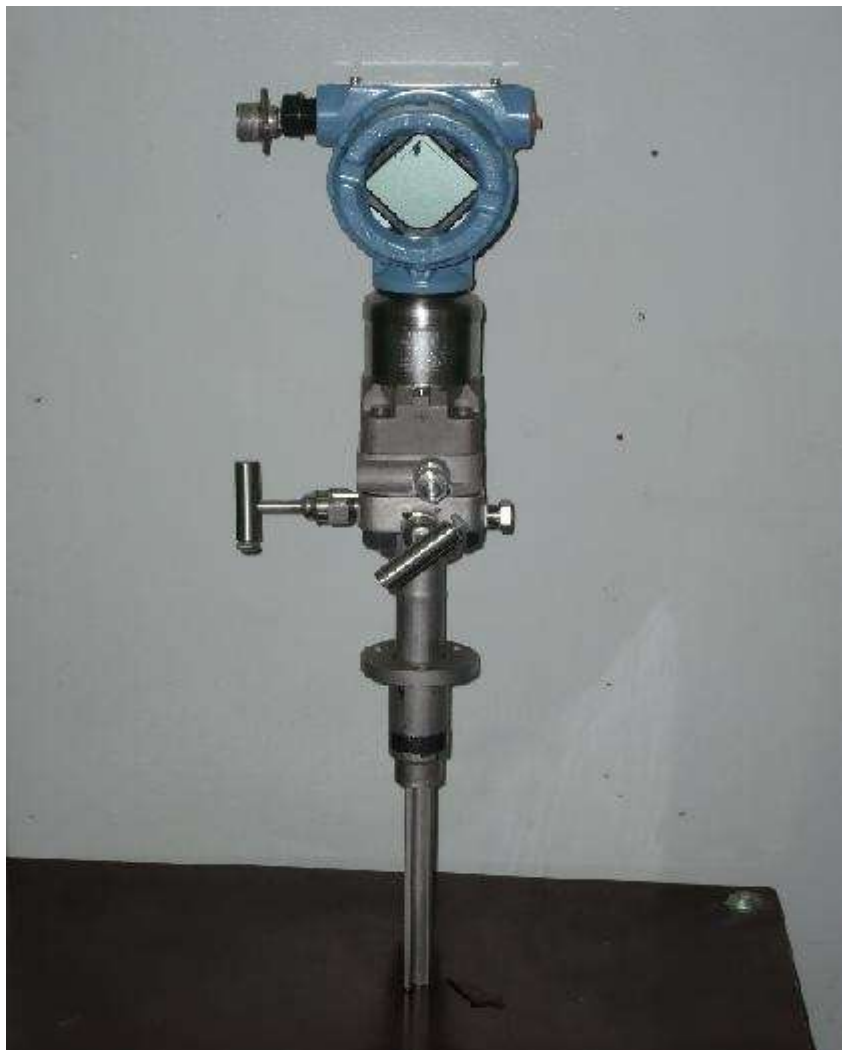
Рисунок 1 - Общий вид расходомера Метран-350
