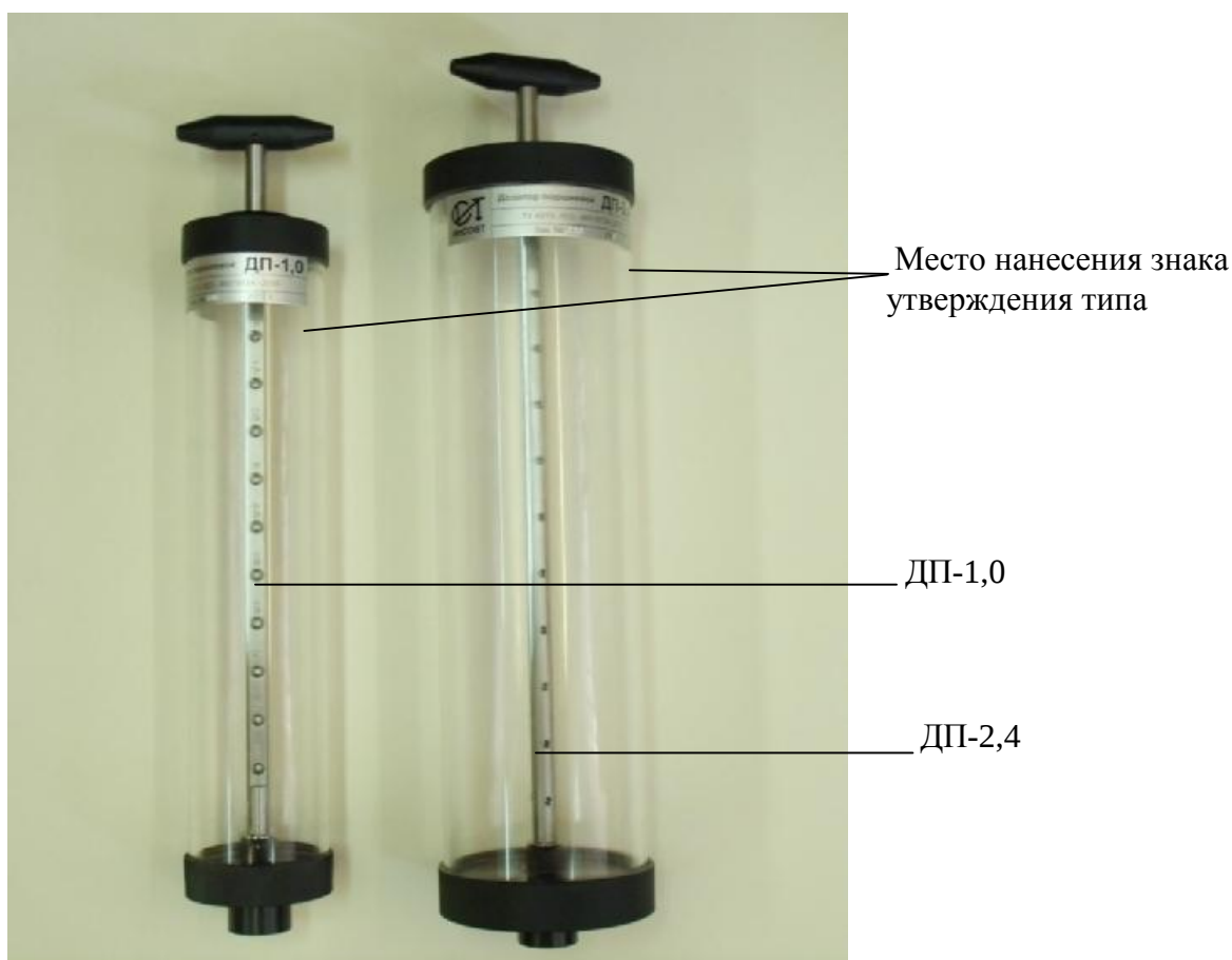
Рисунок 1 - Общий вид дозаторов поршневых: ДП-2,4; ДП-1,0
