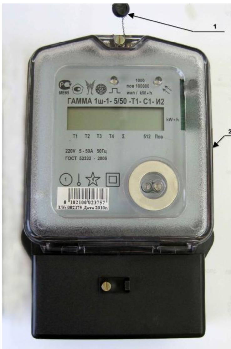
1 - пломба поверителя; 2 - места обклейки гарантийными наклейками завода-изготовителя.
