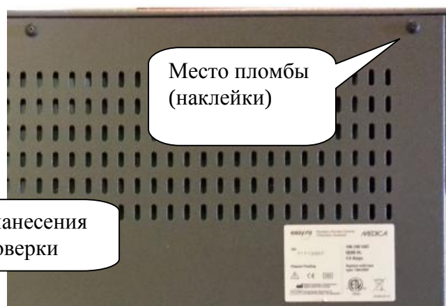
Рисунок 2 – Анализатор биохимический автоматический EasyRA. Расположение пломбы (наклейки)
