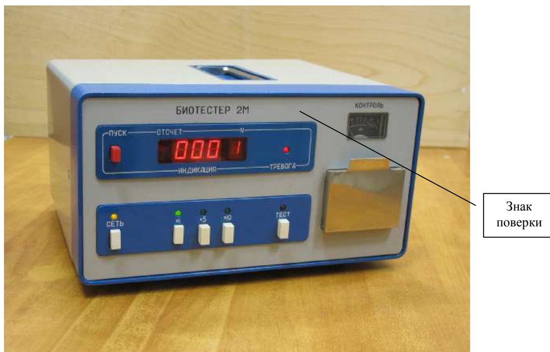
Рисунок 1 – Внешний вид концентратора «БИОТЕСТЕР-2М»
