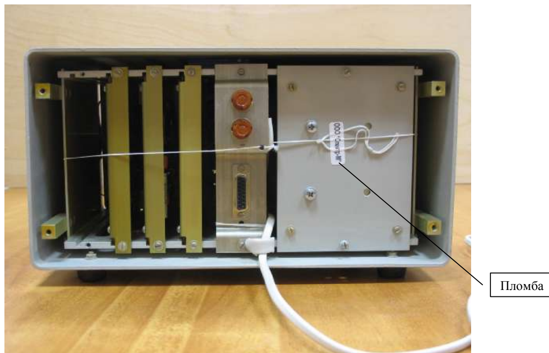
Рисунок 2 – Вид сзади концентратора «БИОТЕСТЕР-2М»
