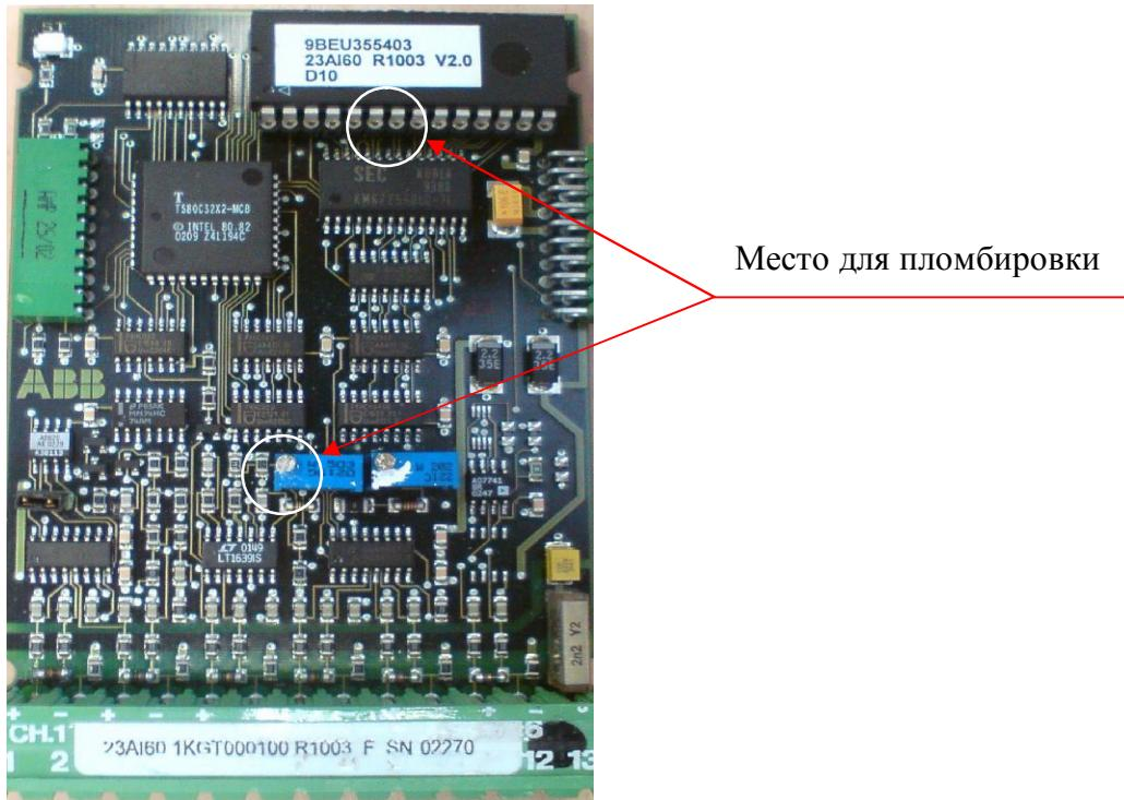
д) модуль аналоговых входов 23AI60 (В корпус RTU 211 монтируются платы ввода/вывода данных типа 23AI60 и адаптер типа 23AD62 для обеспечения связи с процессорным модулем типа CMG10, CIG10).
