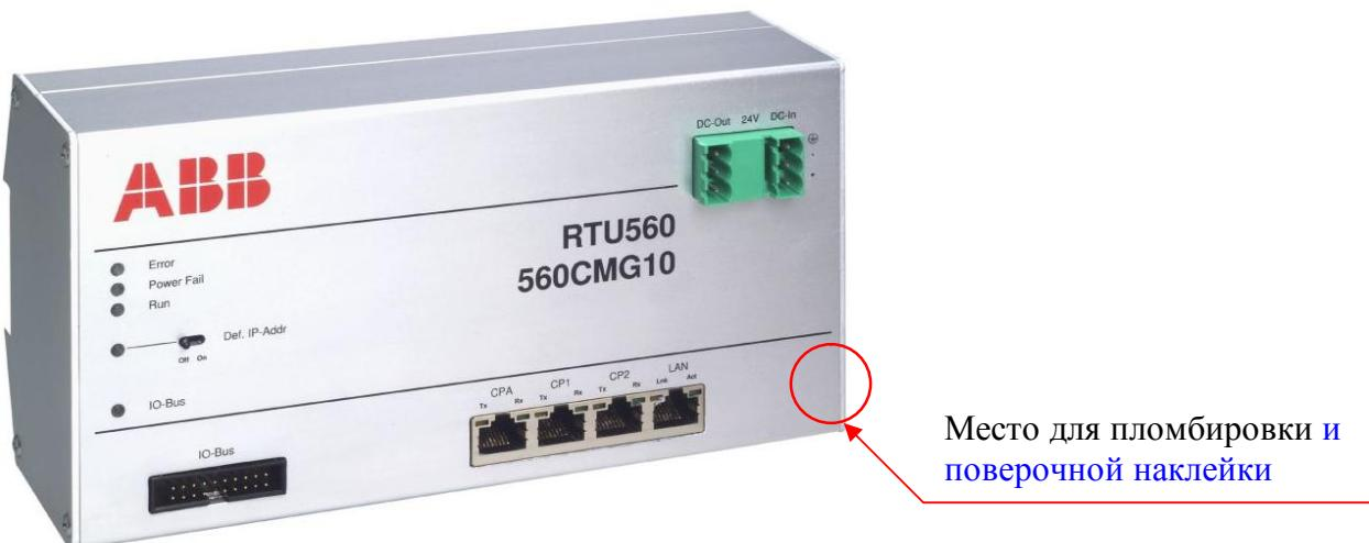
в) RTU 560G - исполнение на DIN-рейке;
