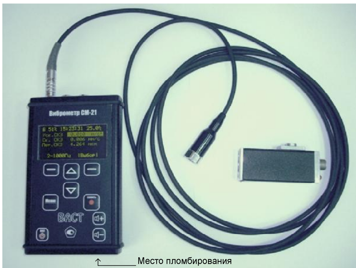
Рисунок 1. Внешний вид и место пломбирования виброметра СМ-21
