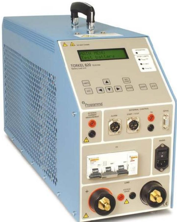
Напряжение, сила тока, время разряда аккумуляторной батареи измеряются и выводятся на дисплей в процессе разряда, и после его остановки по условиям истечении заданного времени или достижения заданного напряжения. По результатам разряда измерители вычисляют емкость аккумуляторных батарей.
