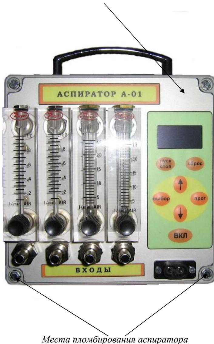
Рисунок 1 - Внешний вид аспираторов
