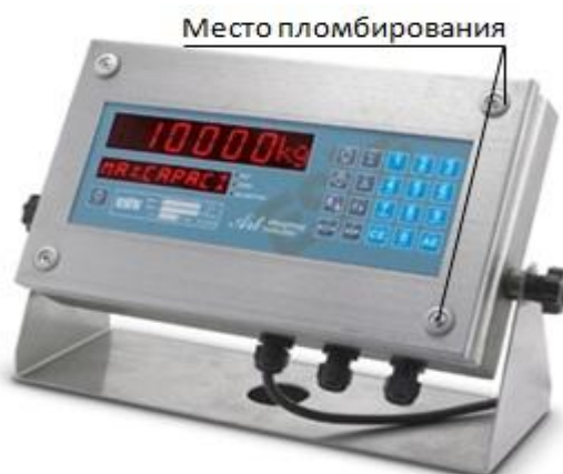
Рисунок 5 — Место пломбировки индикатора ART-S (пломбировка мастикой в пломбировочной чашке, свинцовой пломбой или разрушаемой наклейкой)
