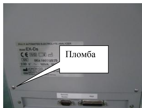
Рисунок 4 – Анализатор электролитов крови EX для лабораторной диагностики in vitro, модели EX-Ds. Расположение пломбы
