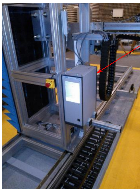
Рисунок 2 – Внешний вид контроллера, предназначенного для управления работой сканера
