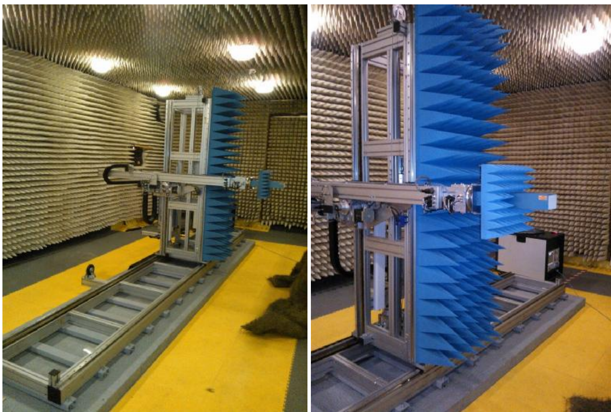
Рисунок 1 – Внешний вид сканера с установленной антенной-зондом
