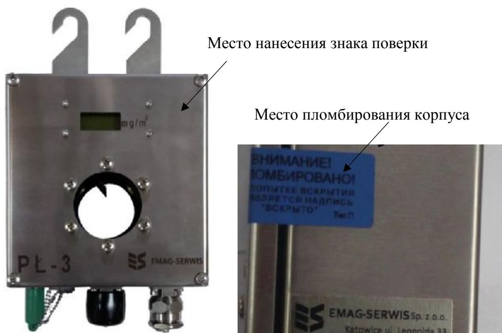
Рисунок 1 – Внешний вид пылемеров PL-3 с указанием способов пломбировки корпуса и нанесения знака поверки
