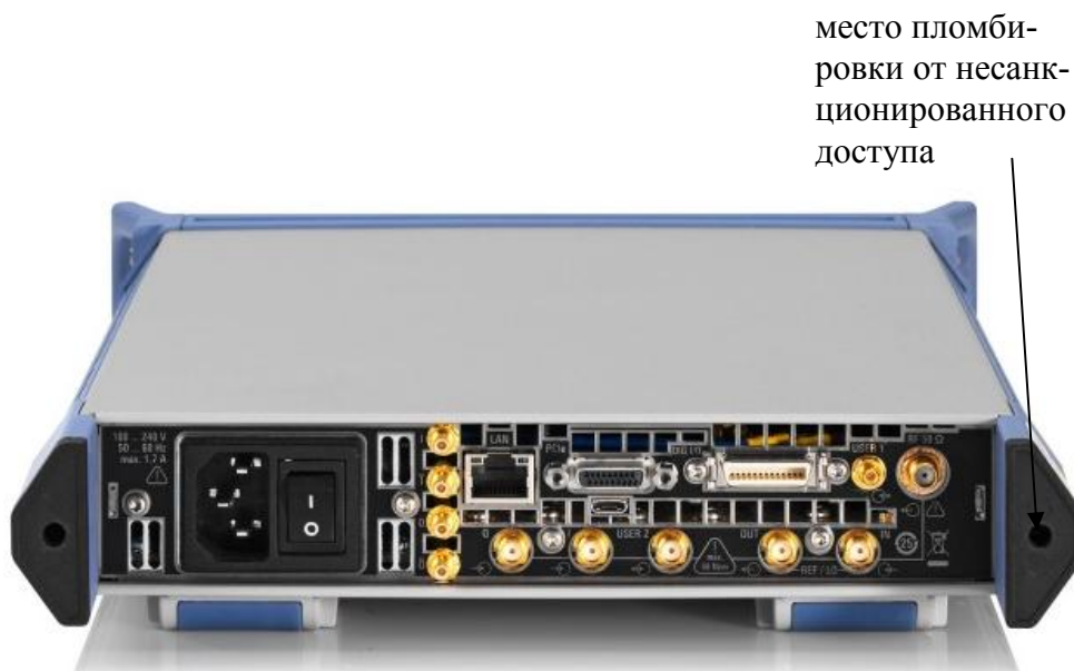
Рисунок 2 - Схема пломбировки от несанкционированного доступа
