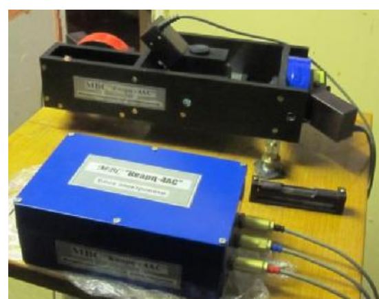
Рисунок 2 - Общий вид магнитоизмерительных преобразователей со схемой пломбировки от несанкционированного доступа
