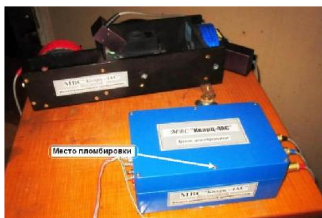
Рисунок 2 - Общий вид магнитоизмерительных преобразователей со схемой пломбировки от несанкционированного доступа
