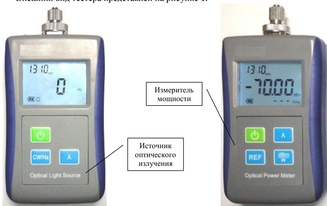
Рисунок 1 – Внешний вид волоконно-оптического тестера ОТМ-1
